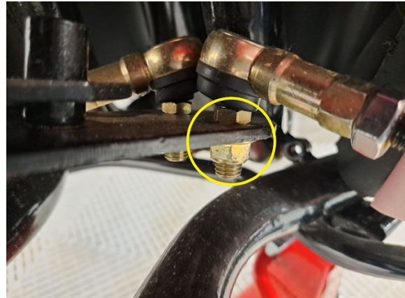
Irrota raidetangon sisäpään kiinnitysmutteri. (kiintoavain 14 mm). Jos raidetangon pää pyörii tyhjä, niin raidetangon pään suojakumin puolella on kohta, josta voi pitää kiinni. (kiintoavain 12 mm).
