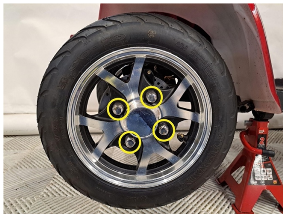
Irrota etupyörän kiinnitysmutterit. (hylsy 19 mm).
