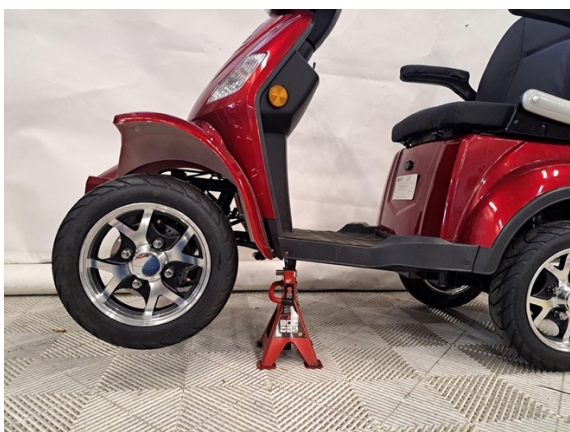
Nosta laitteen etupää korokkeelle.
