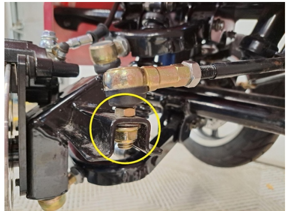
Irrota raidetangon pään mutteri. (hylsy 14 mm). Jos raidetangon pää pyörii tyhjä, niin raidetangon pään suojakumin puolella on kohta, josta voi pitää kiinni. (kiintoavain 12 mm).
