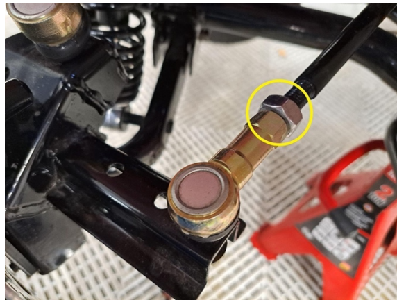
Löysää hieman raidetangon päiden lukitusmutteria. (kiintoavain 17 mm).
