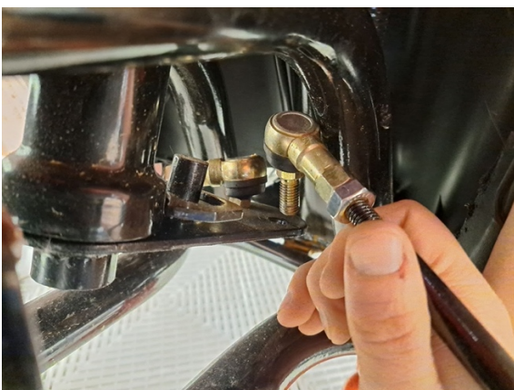
Irrota raidetangon sisäpää ohjausakselista.
